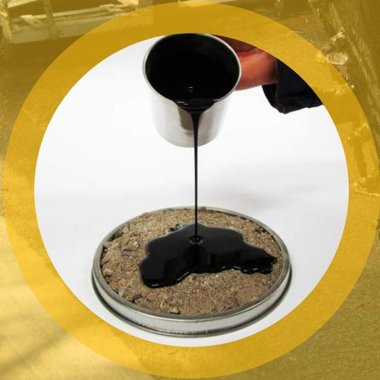
*El Asfalto Líquido Multinsa es una mezcla de cementos asfálticos con solventes hidrocarbonados volátiles destilados del petróleo, que provee al asfalto diluido un tiempo de curado medio. Su aplicación en los riegos de superficies es homogénea gracias a su consistencia.*
